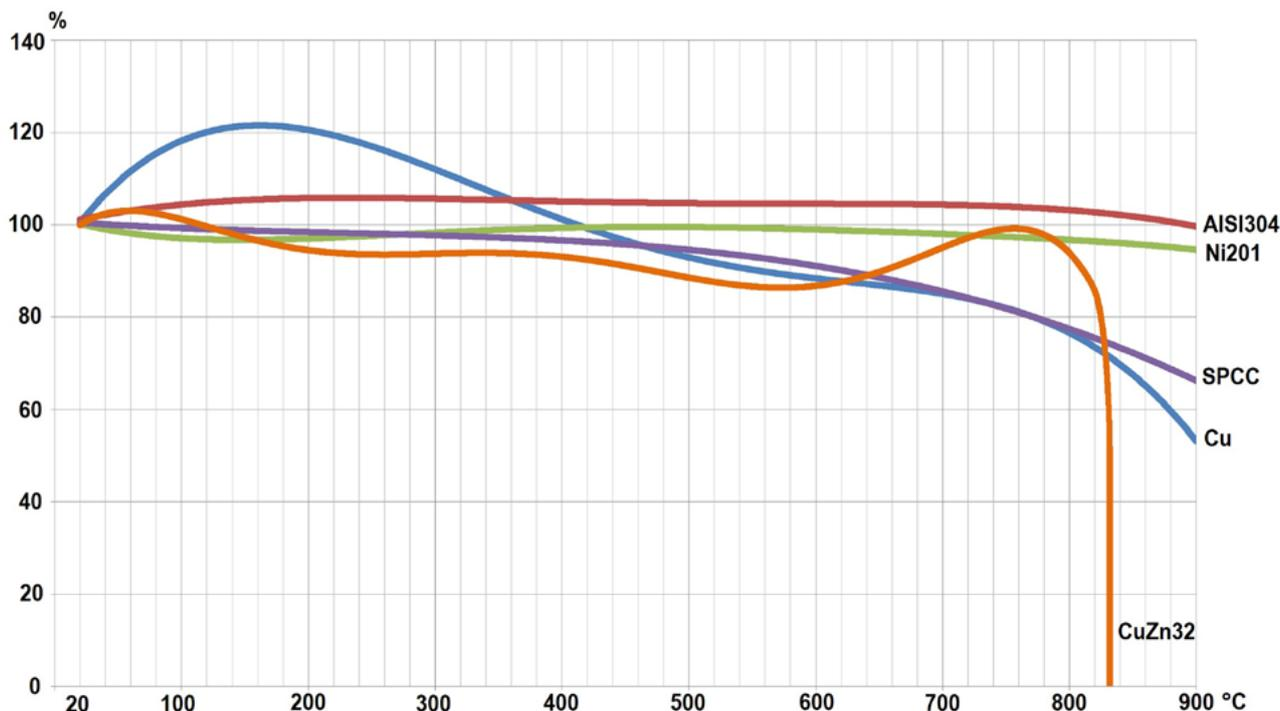
Медь и сталь постепенно теряют механическую прочность, сохраняя лишь около 50% при температуре около 900°C. Латунь остается относительно стабильной, но достигает точки плавления непосредственно перед температурой 900°C. Нержавеющая сталь 304 и никель 201 не демонстрируют существенных изменений механической прочности до 900°C.
