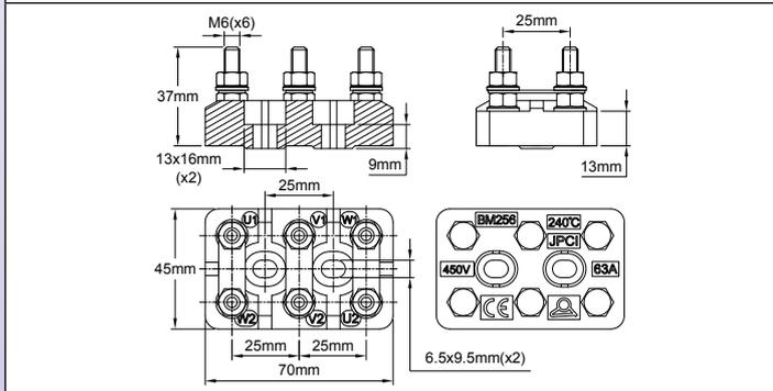
**Модель 63 А 450 В (расстояние между клеммными зажимами 25 мм, винты М6)**
