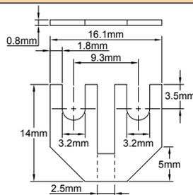
Перемычка с двумя пазами, расстояние между осевыми линиями пазов 9,3 мм, подходит для колодок серии ВЕ с поперечным сечением 2,5 мм<sup>2</sup>.
