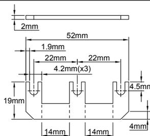
Перемычка с тремя пазами, расстояние между осевыми линиями пазов 20 мм, подходит для колодок серии ВСА и ВСВ.
