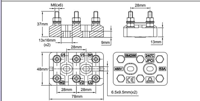
**Модель 63 А 450 В (расстояние между клеммными зажимами 28 мм, винты М6)**
