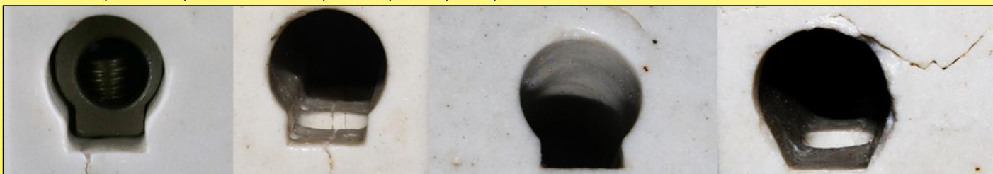
Примеры трещин на фарфоре С111
