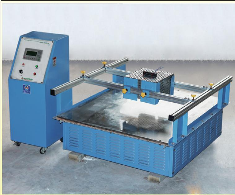
Оборудование для выполнения испытания на устойчивость к вибрации
