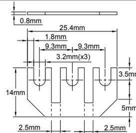
Перемычка с тремя пазами, расстояние между осевыми линиями пазов 9,3 мм, подходит для колодок серии ВЕ с поперечным сечением 2,5 мм<sup>2</sup>.
