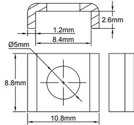
Подкладка для винтов М4, отверстие 5 мм, устанавливается в керамические клеммные колодки серии ВСА, ВСВ и ВСС.
