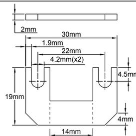
Перемычка с двумя пазами, расстояние между осевыми линиями пазов 20 мм, подходит для колодок серии ВСА и ВСВ.
