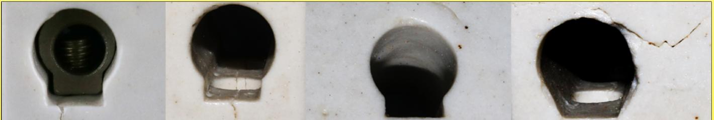
Примеры трещин на фарфоре C111
