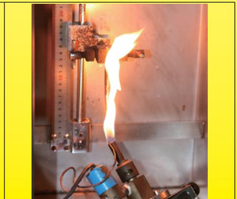
Образец во время испытания на UL94V0
