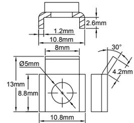
Навесная перемычка для винтов М4 с защитой от разрезания, отверстие 5 мм, устанавливается на клеммные зажимы керамических клеммных колодок серии ВСА, ВСВ. Не подходит для использования с колодками серии ВСС.
