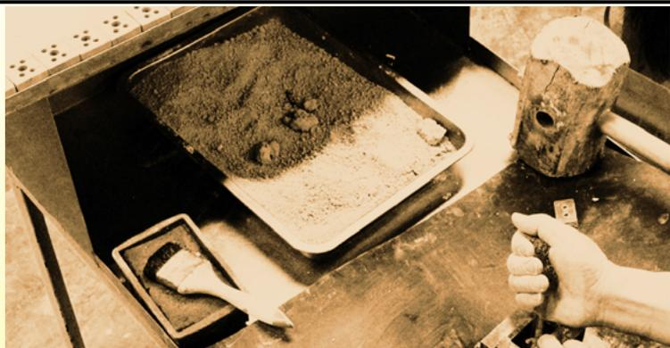
Клеменные колодки из фарфора, сделанные вручную путем прессования молотком: заполнение влажным гранулятом вручную (частная коллекция). Сушка электротехнического фарфора после прессования (частная коллекция).
