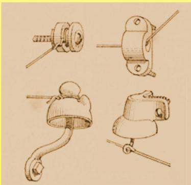
1881 год. Фарфоровые изоляторы для электрических распределительных устройств и дверных звонков на батареях (Dictionnaire des termes Employés Dans La Construction, Pierre Chabat)
