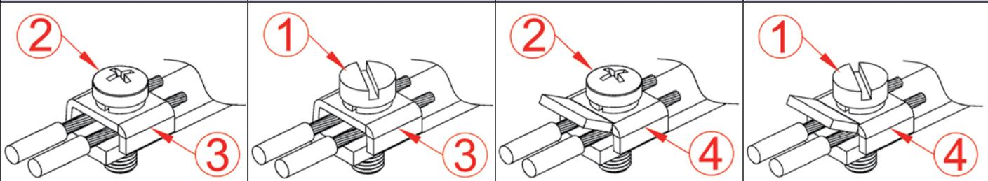
1 — плоская цилиндрическая головка со шлицем под отвертку; 2 — полусферическая головка со шлицем Pozidriv; 3 — простая подкладка; 4 — подкладка с предохранительным выступом для защиты от разрезания
